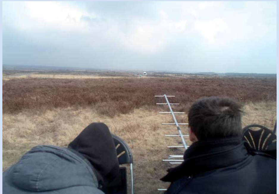
Abb. 10: Mithilfe von Yagi-Antennen werden die Daten vom CanSat empfangen.
